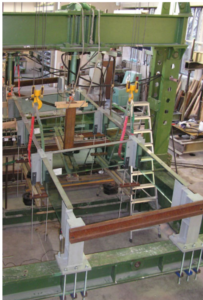
Bild 6. Tragfähigkeitsprüfung der Glaskonstruktion in der Prüfhalle des Instituts für Baukonstruktion an der Technischen Universität Dresden
